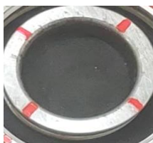
ภาพที่ 3 การกำหนดจุดเพื่อที่จะวัดหาค่าความเรียบผิว ( R_a, R_z ) ของ \varnothing D .
